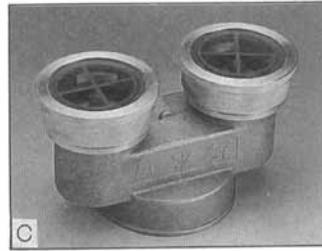
■消防立管數在2支以下時，應設置雙口式送水口1個，並附快速接頭，3支以上時，設置2個。
