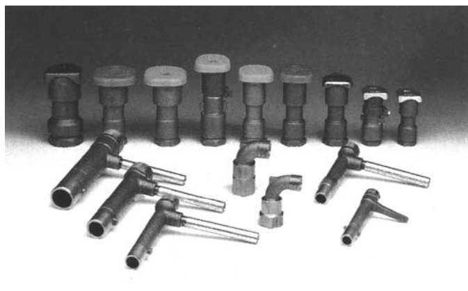
快速給水閥及插桿 1.鑄銅材質 2.口徑 3/4"~1 1/2" § 3.可連接各口徑水管
